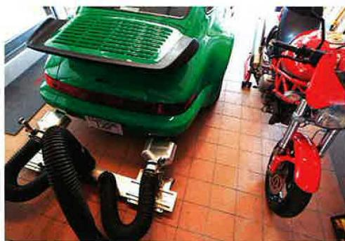
ポルシェのマフラーの幅に合わせてアジャストができるようになっているダブルタイプのアタッチメント。アルミ形状なので軽く、移動式もイージー。
